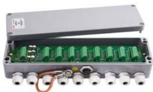
In poliestere consente di collegare fino a 10 celle di carico; progettata per essere installata su pese a ponte e silos con protezione IP66, è dotata di limitatori per la sovratensione e protezione contro i fulmini. Alla scatola di giunzione è collegato un cavo verso la strumentazione elettronica.
