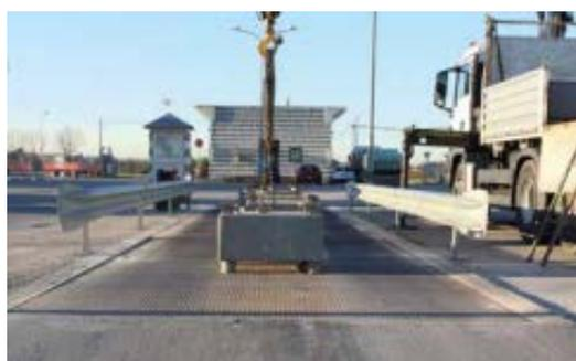
**Con le pese a ponte modulari NON si effettuano interventi e/o manutenzioni all'interno della vasca di contenimento delle stesse.** La taratura avviene con i pesi campione posizionati sulla piattaforma e con la verifica visiva di pesatura tramite il terminale di pesatura. Le VERIFICHE DI QUALITÀ sono consigliate OGNI ANNO. Le VERIFICHE PERIODICHE di legge ogni 3 ANNI.
