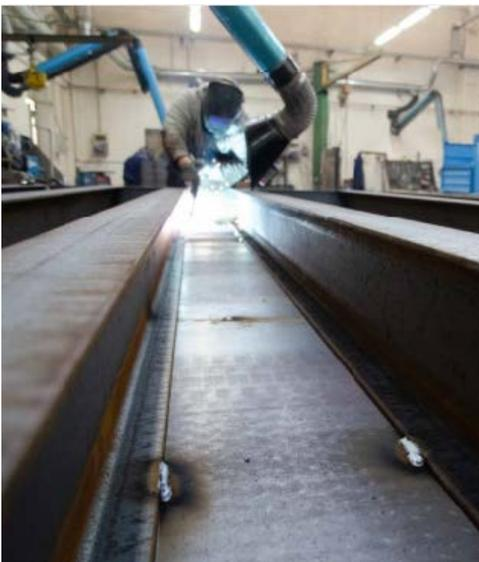
La pesa a ponte "modulare" viene costruita in MODULI di 3 dim 4,5 X 3 m circa cad; ogni modulo viene assemblato con travi Ipe. Le travi vengono poi saldate alle lamiere di copertura bugnata spessore 10 mm.
